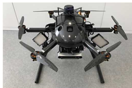
高所点検ドローン
